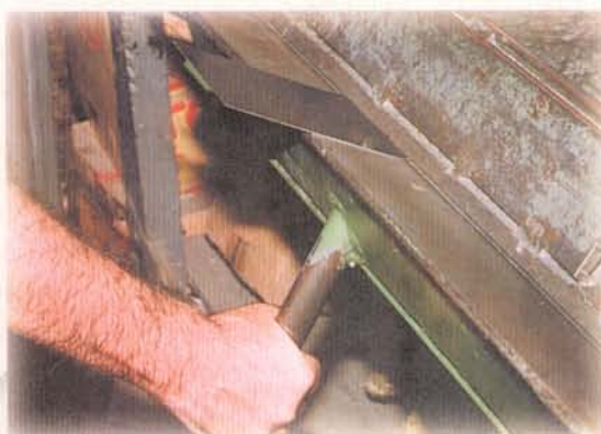
Figura 8.23. Operación de doblado del chasis en una dobladora pequeña
